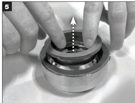
Déposez la bague d'étanchéité stationnaire du chapeau et mettez-la au rebut.
