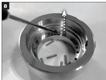
Déposez tous les ressorts des orifices de ressort du chapeau et mettez-les au rebut.
