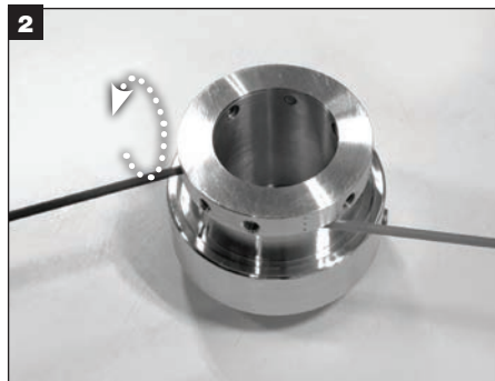
Déposez toutes les vis sans tête à cuvette et à téton 1/4 po de la bague de verrouillage et mettez-les au rebut.
