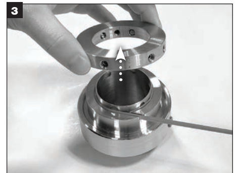
Déposez la bague de verrouillage de la chemise et mettez-la de côté. Retirez la languette de centrage.
