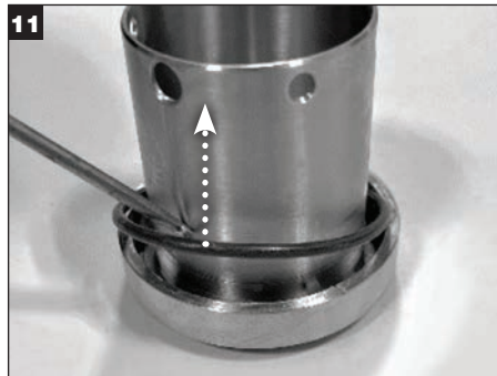
Déposez le joint torique (W) de la rainure de joint torique de la chemise et mettez-le au rebut.
