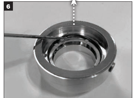
Déposez le joint torique (X) de la rainure de joint torique du chapeau et mettez-le au rebut.
